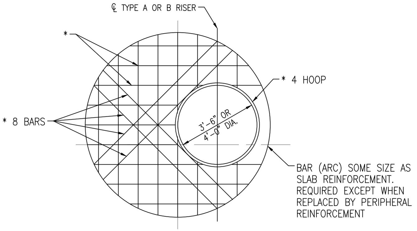
**TOP SLAB REINFORCING STEEL DIAGRAM**
